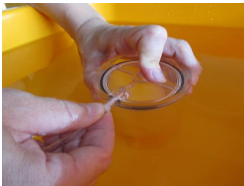
Obr. 2 Nasávanie vody do zvona vývevy
