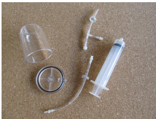
Obr. 1 Žiacka vákuová súprava – zvon, hadičky s jednocestnými ventilmi, striekačka
